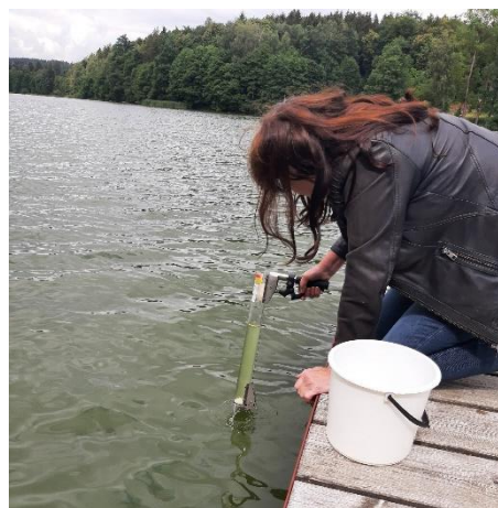
Obr. 8 a 9 Odběr vzorků pomocí povrchového vzorkovače (Andělova tyč).
