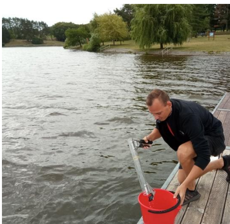
Obr. 8 a 9 Odběr vzorků pomocí povrchového vzorkovače (Andělova tyč).
