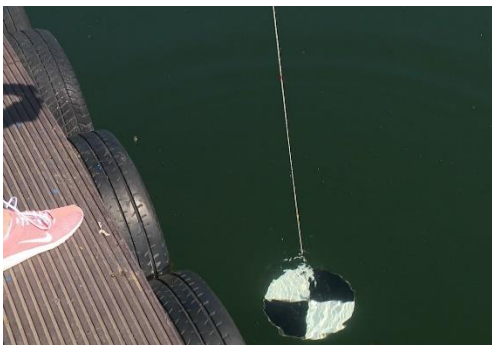
Obr. 5 Měření průhlednosti pomocí Secchiho desky na Štěrkovišti Otrokovice.
