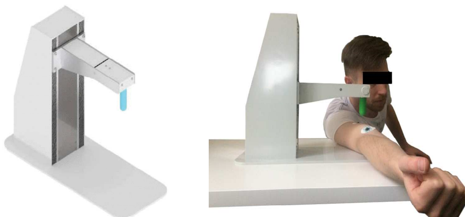
Obr. 30: Zařízení pro měření viskoelasticity tkáně „Myotonometer“ (vlevo) a reálný setup při realizaci měření (vpravo).
